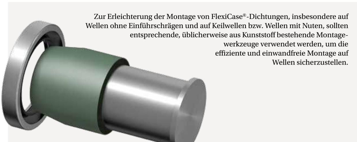
Zur Erleichterung der Montage von FlexiCase®-Dichtungen, insbesondere auf Wellen ohne Einführschrägen und auf Keilwellen bzw. Wellen mit Nuten, sollten entsprechende, üblicherweise aus Kunststoff bestehende Montagewerkzeuge verwendet werden, um die effiziente und einwandfreie Montage auf Wellen sicherzustellen.
